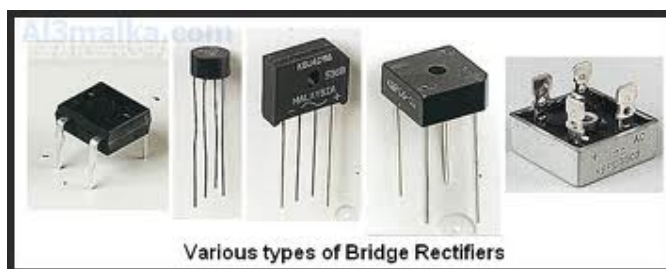
شکل (۱-۲) نمایی از برخی پل دیودها
