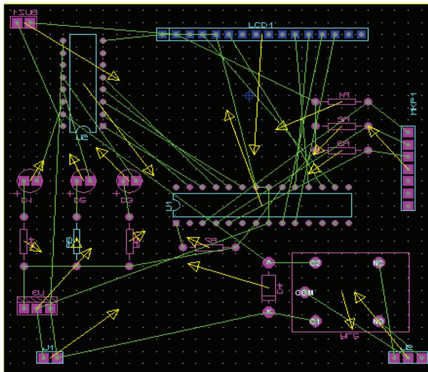
در این نرم افزار نیز مانند پروتل می‌توانید از چیدمان اتماتیک استفاده کنید ، برای این کار از منوی Tools گزینه ی Auto Placer را انتخاب کنید ، در پنجره ای که با انتخاب این گزینه باز می شود ، می‌توانید معین کنید که کدام قطعات در چیدمان خود کار وجود داشته باشند و فاصله بین آنها چقدر باشد . بعد از اعمال تنظیمات روی ok کلیک کنید ، مشاهده میکنید که قطعات در کمترین فضای ممکن چیده میشوند .
