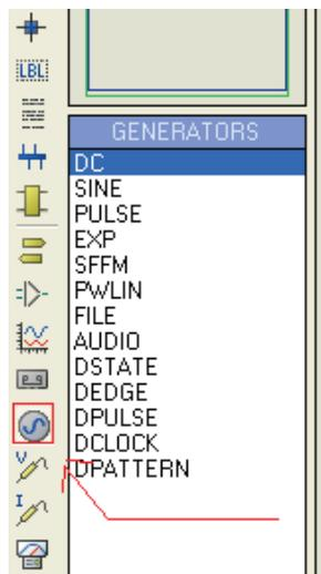
اولین منبع ، منبع ولتاژ dc میباشد ، این منبع میتواند یک ولتاژ dc را تامین کند ، مدار زیر را در پروتوس رسم کنید :
