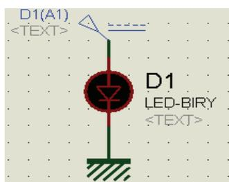
اکنون بر روی منبع کلیک کنید (توجه کنید که ولتاژ این منبع نسبت به گراند اعمال میشود، بنابراین وجود گراند در مدار ضروری است) پنجره ای مانند زیر باز میشود، تنظیمات را مطابق شکل اعمال کنید:
