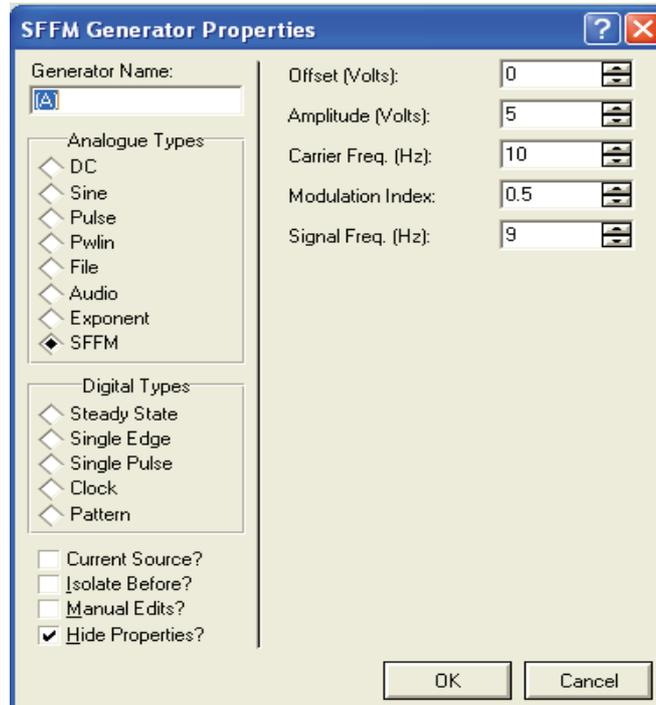
در پنجره بالا offset مقدار سطح dc اضافه شده به ولتاژ است همچنین amplitude دامنه ولتاژ هر دو شکل موج را مشخص میکند.
