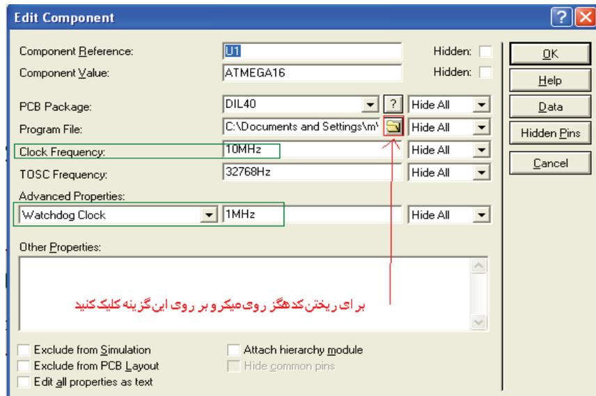
بعد از اعمال تنظیمات بر روی ok کلیک کنید ، مدار شما آماده شبیه سازی است ، در قسمت کنترل بر روی play کلیک کنید تا شبیه سازی شروع شود ، مشاهده میکنید که دمای نمایش داده شده بر روی سنسور بر روی lcd نیز نمایش داده می شود:
