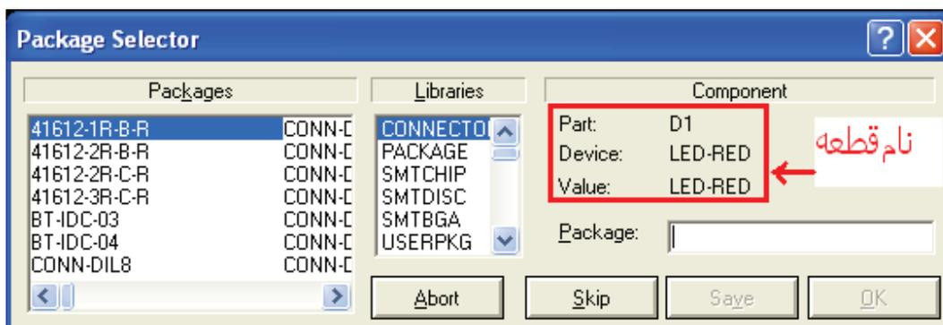
در صورتی که با پیغام زیر روبرو شدید مدل pcb انتخاب شده مناسب قطعه نمیباشد و شما باید یک مدل دیگر را انتخاب کنید (معمولا در پروتوس از هر قطعه چندین نوع وجود دارد ، موارد دیگر را انتخاب کنید) :
