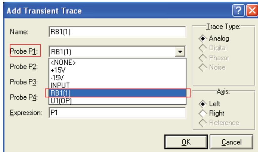
از منوی graph گزینه ی simulate graph را انتخاب کنید میبینید که شکل موج ورودی به نمایش در می آید ، در صورتی که مایل به نمایش شکل موج های دیگر در کنار این شکل موج هستید ، از منوی Graph گزینه ی ADD Trace را انتخاب کنید و شکل موج دیگری را نیز اضافه کنید ، توجه داشته باشید که پس از اعمال هر شکل موج باید بر روی ok کلیک کنید و گزینه ی simulate graph را بزینید تا شکل موج به نمایش در آید . در صورتی که این پنجره را ببینید ، شکل موج ها در داخل پنجره اصلی به نمایش در میاید:
