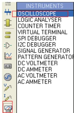
از پانل generators یک منبع ولتاژ سینوسی بیاورد و ان را به کانال a اسیلوسکوپ متصل کنید :
