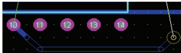
در صورتی که مسیری جلو شماسست در یک مکان مناسب (منظور از مکان مناسب جایی است که در مسیر جامپر قطعه یا چیزی نباشد ، همچنین پایه جامپر به خطوط دیگر برخورد نکند و...) دوبار کلیک راست کنید تا بتوانید یک جامپر بزنید :
