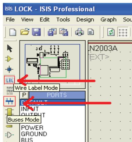
کار wire lable mode ، مشابه ابزار های قبلی میباشد ، و تنها تفاوت در سنبل گرافیکی میباشد .
