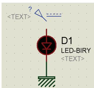
سپس آن را با سیم به مدار متصل کنید (موس را روی نقطه مورد نظر از مدار ببرید (مثبت led)، هنگامی که ایکون فلش موس به مدار تبدیل شد، بر روی نقطه کلیک کنید و مسیر را تا منبع ادامه دهید):
