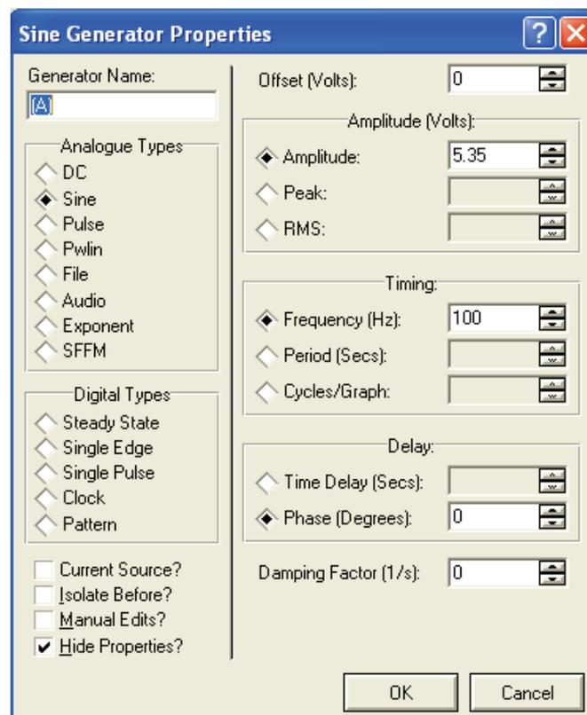
مقادیر موجود در شکل بالا را وارد کنید و شبیه سازی را آغاز نمایید مشاهده میکنید که شکل موجی با فرکانس 100 هرتز و ولتاژ 5.35 ولت روی اسیلوسکوپ نمایش داده میشود .
