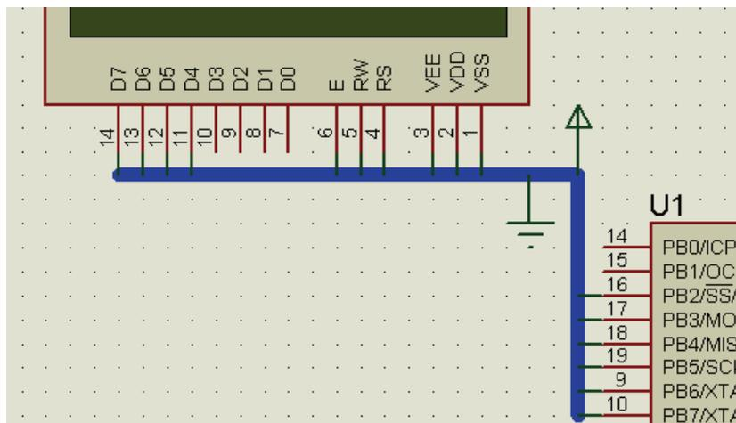
بعد اتصال پایه های مورد نیاز ، از نوار ابزار سمت چپ گزینه ی WIRE LABEL MODE را انتخاب کنید و با کلیک کردن روی مسیر ها یک نام به انها اختصاص دهید ( در پنجره باز شده نام را وارد کنید و سپس روی ok کلیک نمایید) و در نهایت کلیه مسیر های هم نام به یکدیگر متصل میشوند:
