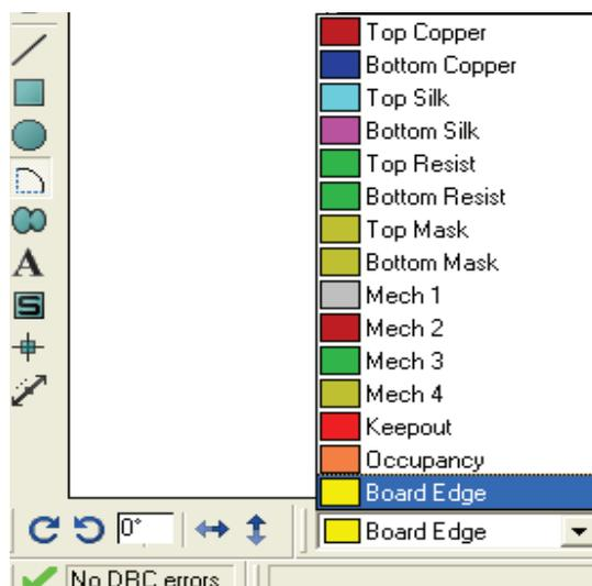
در صفحه یک مربع رسم کنید (به اندازه دلخواه و مناسب) (همانطور که مشاهده میکنید رنگ مربع زرد است) ، اکنون در نوار ابزار سمت چپ بر روی گزینه ی component mode کلیک کنید و بعد از ظاهر شدن قطعات در قسمت COMPONENTS بر روی اولین گزینه (buz1) کلیک نمایید و سپس در یک مکان مناسب در کادر زرد کلیک کنید تا قطعه در آنجا گذاشته شود ، بر روی دیگر قطعات نیز کلیک کنید تا به صفحه وارد شوند ، با کشیدن (دارگ) کردن قطعات میتوانید آنها را جابجا کنید:
